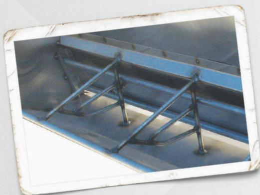
**图片2: 隔板式料槽**
